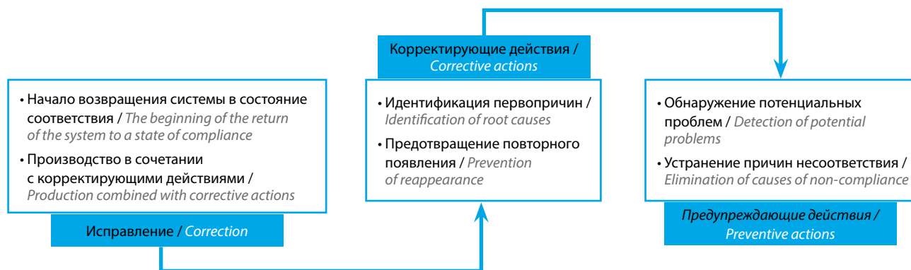
Рис. 2. Элементы процедуры корректирующих и предупреждающих действий (CAPA)
